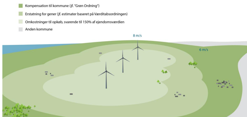
Figur 1 Det lyse område indikerer arealet inden for 4 x møllehøjde, som antages opkøbt, mens husstande i det tilstødende område (4-10 x møllehøjde) kompenseres for gener. (NB: Figuren er ikke i korrekt skala). I tillæg til det illustrerede udbydes også andele af vindmøllen til kostpris. Dette er inkluderet i beregningerne, men ikke nærmere fordelt på husstande og derfor ikke illustreret ved figuren.
